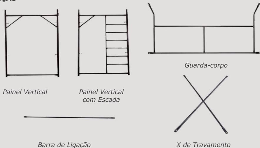
As peças de contraventamento devem ser fixadas nos montantes por meio de encaixe em pinos, devidamente travadas ou contrapinos, de modo que assegurem a estabilidade e o alinhamento necessário ao andamento.
